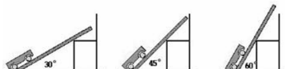
شکل ۱-۱۴: کار انجام شده توسط گرانش روی کامیون در هر سه حالت برابر است.
